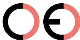
Faux marquage CE (trop éloignée)
